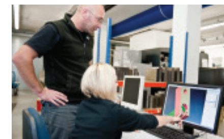
Kameras kontrollieren im Kunststoffspritzguss jedes einzelne Teil auf Maßhaltigkeit.
