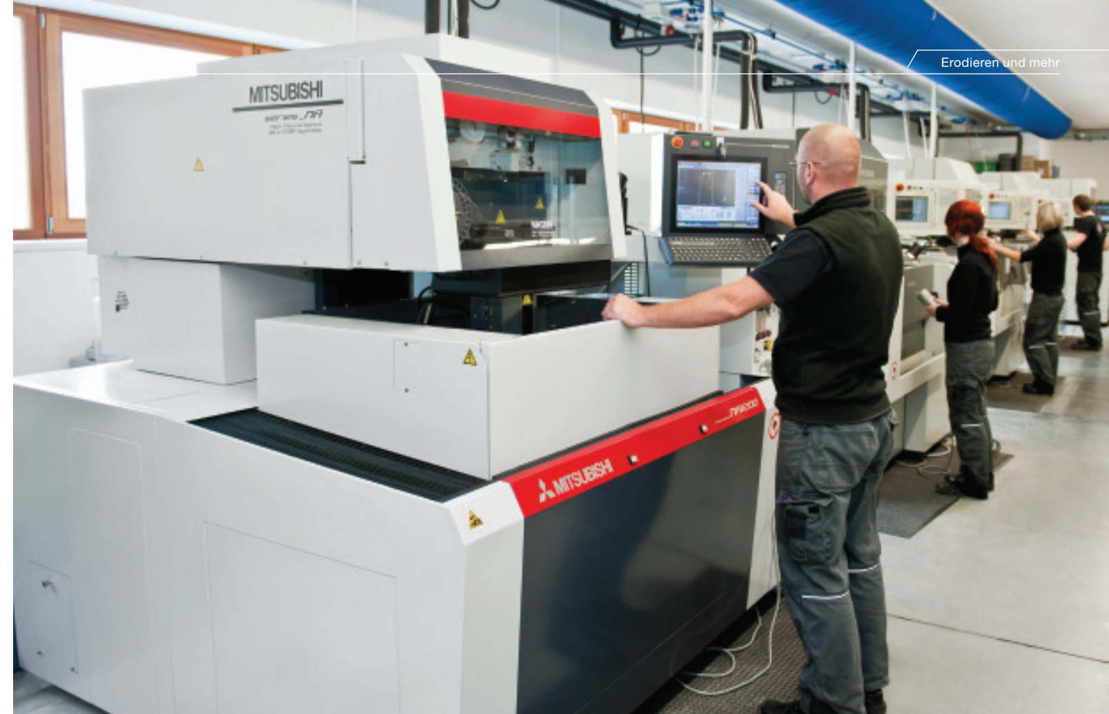
Seit 2001 arbeitet HÖRL mit Drahterodierertechnik von Mitsubishi Electric, Derzeit sind sechs Maschinen im Einsatz.
